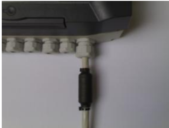
Spôsob uchytenia feritového filtra na napájací kábel
